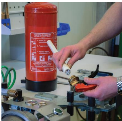
Felszállócső és nyomórugó kiemelése
