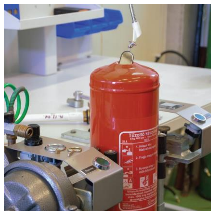
Tartály ellenőrzése tükrös tartályvizsgálóval
