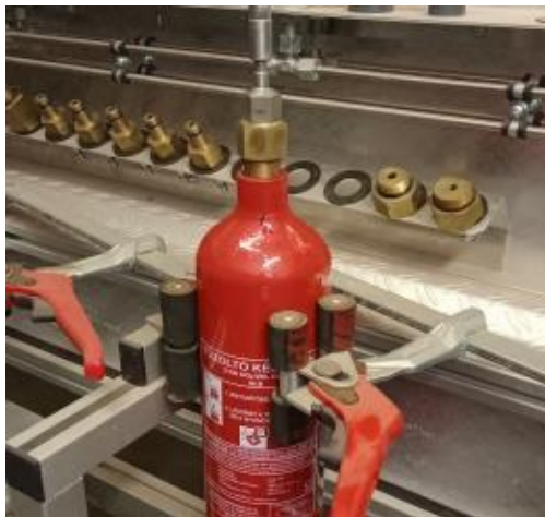
Palack vizes nyomáspróbázása (a palackba beütött gyári érték szerint)
