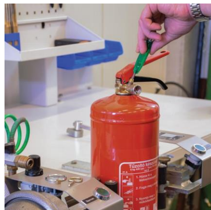
Készülék nyomásmentesítése a szelepbetét eltávolításával
