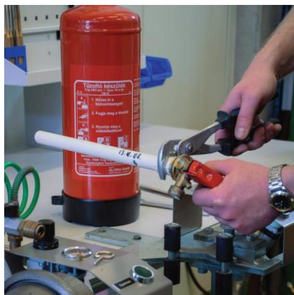
Felszállócső kitekerése a fejszerelvényből
