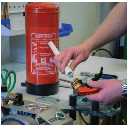
Felszállóső és nyomórúgó kiemelése
