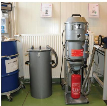
Porvisszatöltés zártrendszerű berendezéssel
