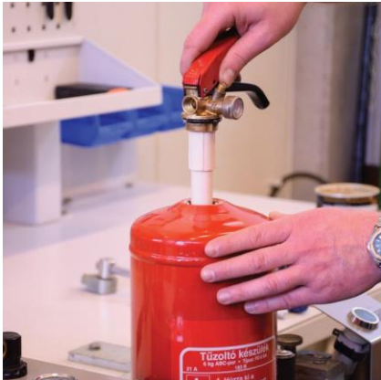
Komplett fejszerelvény függőleges behelyezése a tartályba
