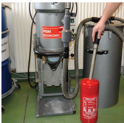
Porkiszívás zártrendszerű berendezéssel
