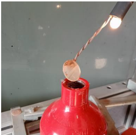
Palack belső állapotának ellenőrzése (pl. tükrös palackvizsgálóval)
