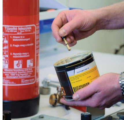
Szelepszár zsírozása, fejszerelvény összeszerelése
