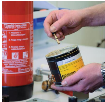
Szelepszár zsírozása, fejszerelvény összeszerelése
