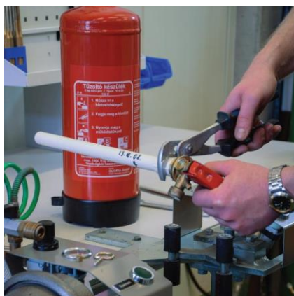
Felszállócső kitekerése a fejszerelvényből
