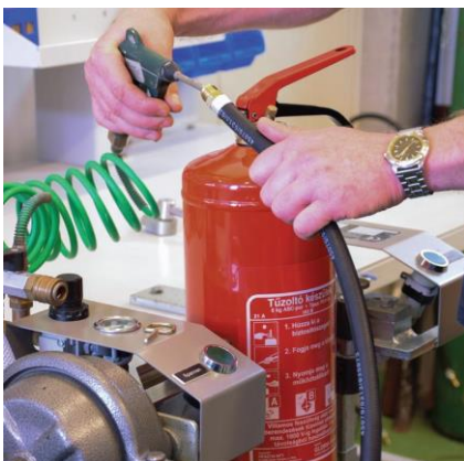
Tömlőszerelvény vizsgálata, kifúvatása sűrített levegővel
