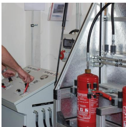
Tartályok nyomáspróbázása (a palástba beütött érték szerint)
