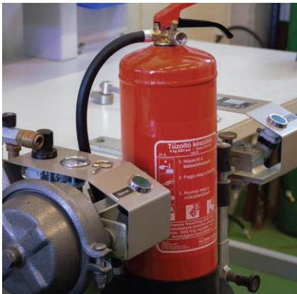
Készülék stabil rögzítése készülékbefogóval
