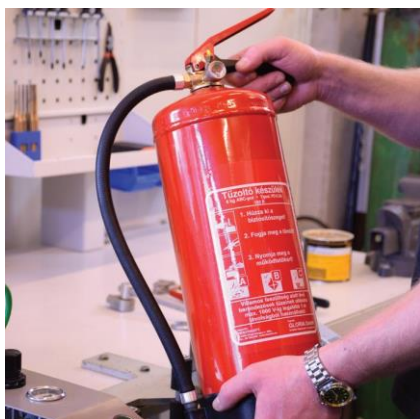
Karbantartott készülék végső szemrevételezése
