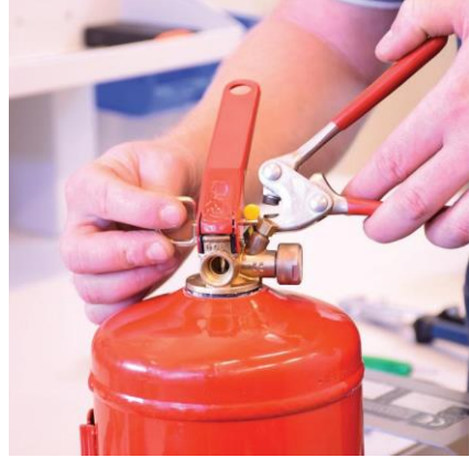
Egyedi azonosítóval ellátott plombafozóval való plombálás, tömlőszerelvény visszaszerelése
