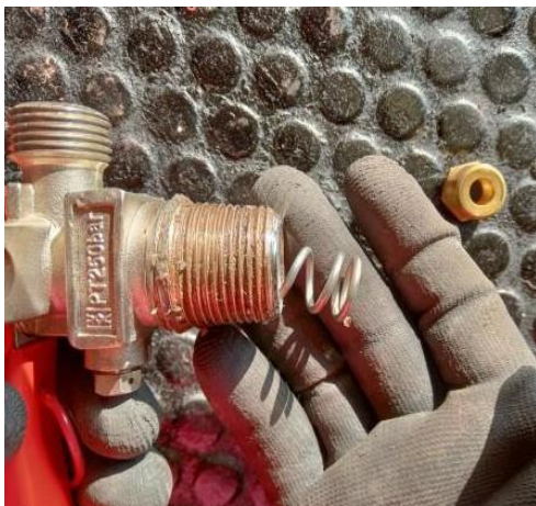
Felszállócső és nyomórugó kiemelése
