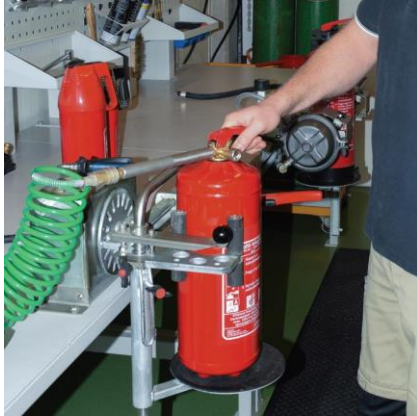
A készüléket nitrogénnel nyomás alá helyezzük
