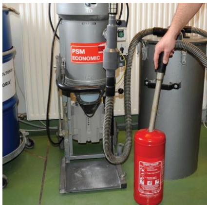
Porkiszívás zártrendszerű berendezéssel
