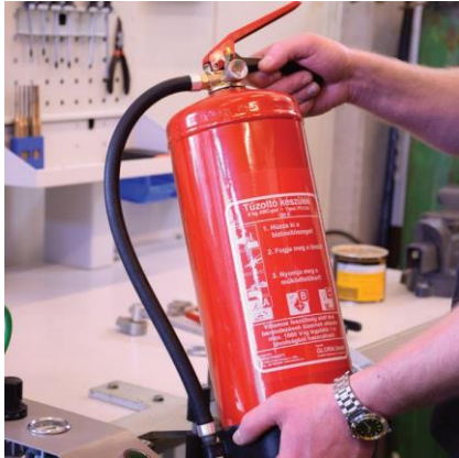
Karbantartott készülék végső szemrevételezése
