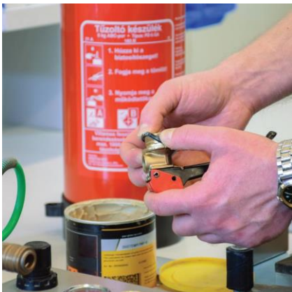
Új O-gyűrű felhelyezése minden karbantartáskor
