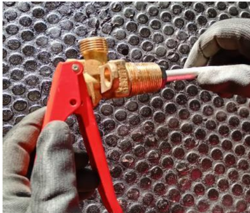
Felszállócső kitekerése a fejszerelvényből
