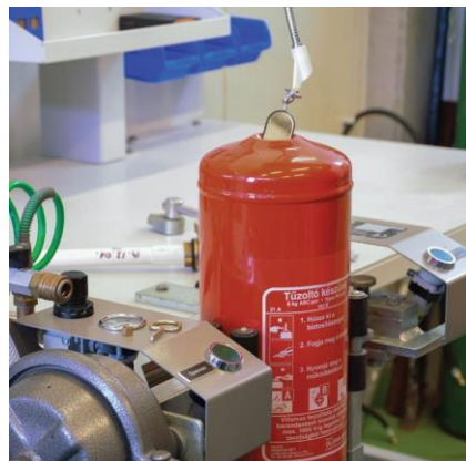
Tartály ellenőrzése tükrös tartályvizsgálóval
