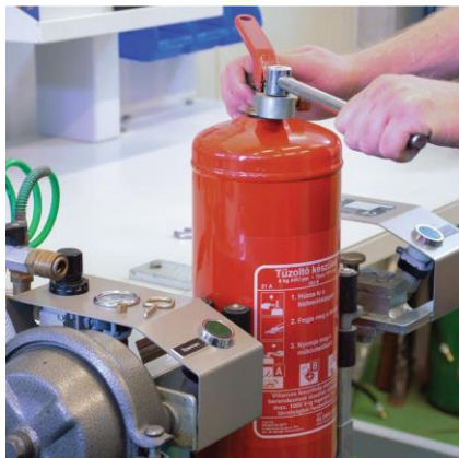
Fejszerelvény kitekerése CSAK NYOMÁSMENTES ÁLLAPOTBAN!
