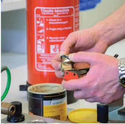
Új O-gyűrű felhelyezése minden karbantartáskor
