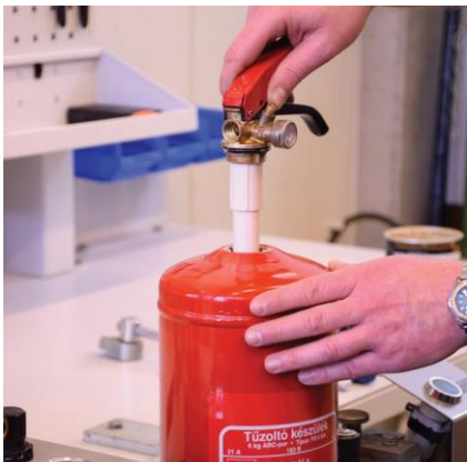
Komplett fejszerelvény függőleges behelyezése a tartályba
