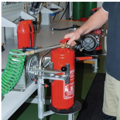
A készüléket nitrogénnel nyomás alá helyezzük
